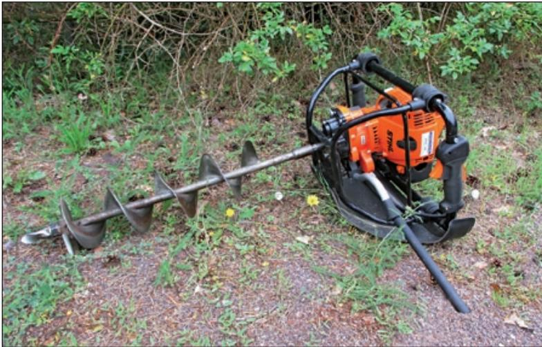
Abb. 13: Einmann-Bohrgerät mit Bohrspindel von Stihl,
